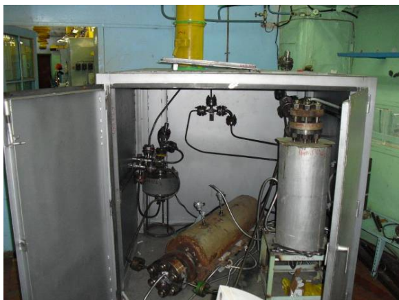
Рис. 3 Стенд коррозионной стойкости
