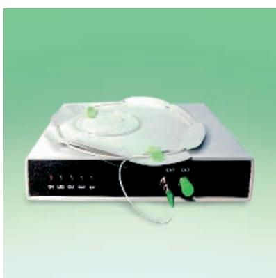
Оптоволоконный денситометр позволяет путем измерения коэффициента отражения от границы торца оптического волокна и среды изучать фазовое поведение одно- и многокомпонентных сверхкритических сред в разных точках реактора.
